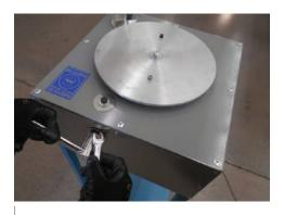
Coloque el maneral en la flecha lateral y apriete el opresor.
