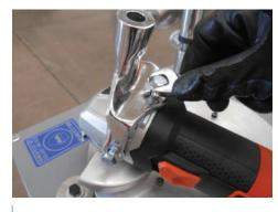
Coloque la abrazadera de aluminio en la pulidora y apriete en los 3 lados con los tornillos incluidos.
