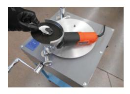
Coloque el disco de corte en la pulidora y apriete.
