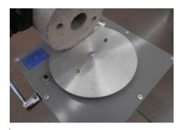
Coloque la piedra en el plato giratorio utilizando las guías.
